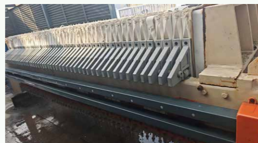
污泥压滤装置
